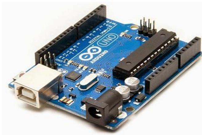
Gambar 2.15 bentuk fisik tampak depan Arduino uno (Sumber: B.gustom, 2016)
