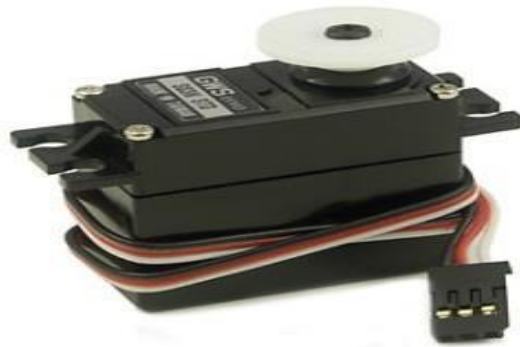
Gambar 2.10 Motor servo (Sumber: febrilio dan ragil, 2018)
