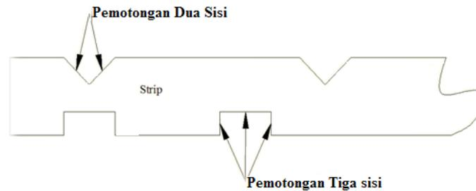
Gambar 2.6 Proses *Notching*
