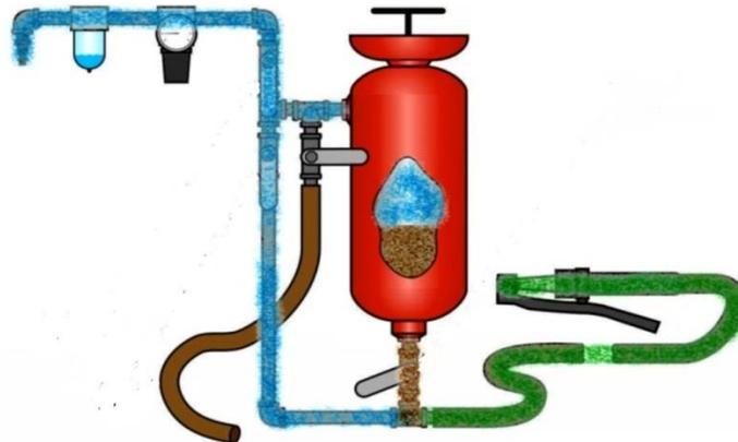
Gambar 2.1. cara kerja mesin sandblasting
