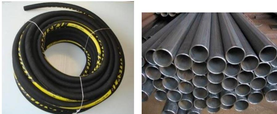
Gambar 2.8 selang dan pipa *sandblasting*
