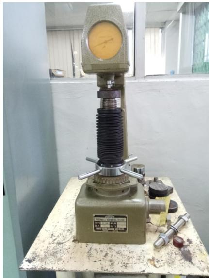
Gambar 2.8 Alat uji kekerasan Rockwell
