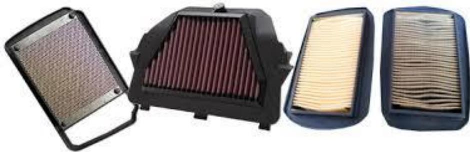
Gambar 2.3 Filter udara bahan kertas basah
