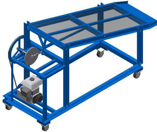
Gambar 2.1 Mesin Pengayak Pasir.
