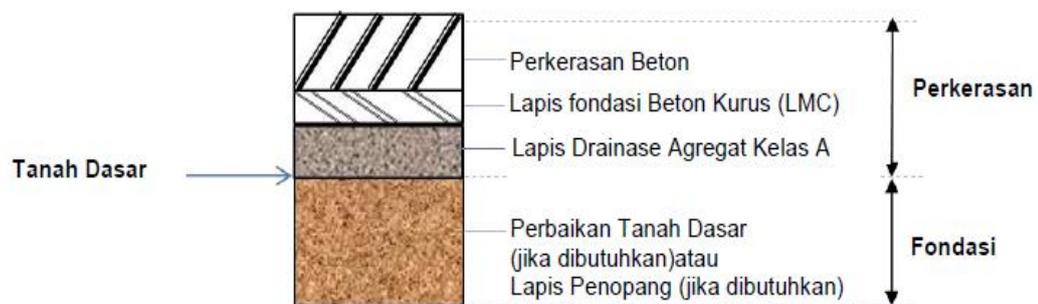
Gambar 2.26 Gambar tipikal perkerasan kaku pada permukaan tanah asli
