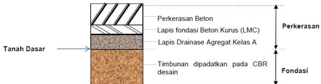
Gambar 2.27 Gambar tipikal perkerasan kaku pada timbunan
