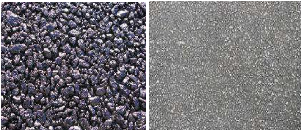
Gambar 2.4 (a) Bentuk permukaan aspal porus (b) Bentuk permukaan aspal padat
