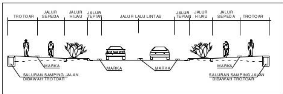
Gambar 2.28 Tipikal potongan melintang jalan 2-lajur-2-arah tak terbagi yang dilengkapi jalur hijau, jalur sepeda, trotoar dan saluran samping
