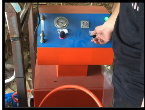
Penyetelan alat foam generator
