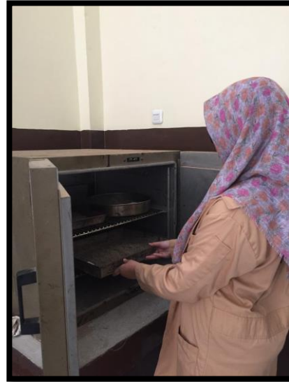
Memasukkan benda uji kedalam oven
