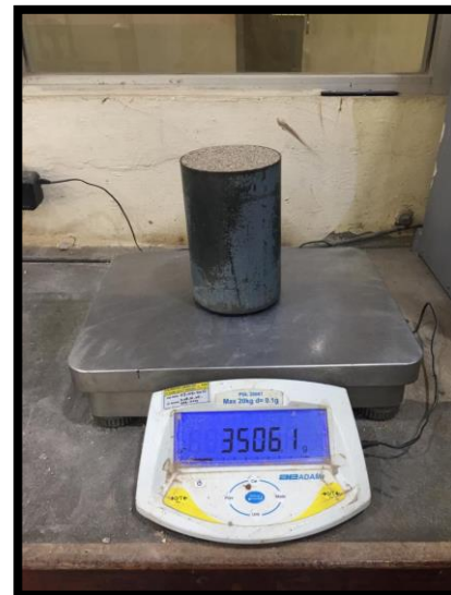
Penimbangan benda uji + tabung silinder
