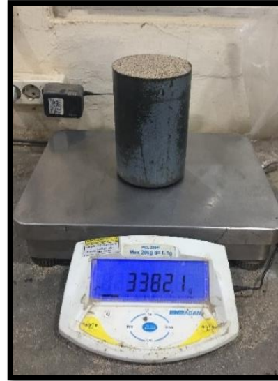
Penimbangan benda uji + tabung silinder
