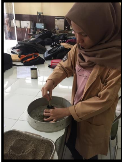
Proses memasukkan dan menumbuk benda uji
