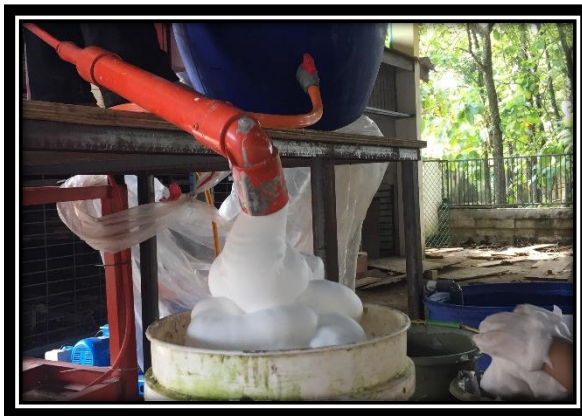
Proses keluarnya busa dari pipa foam generator
