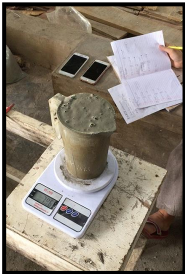
Penimbangan mortar busa
