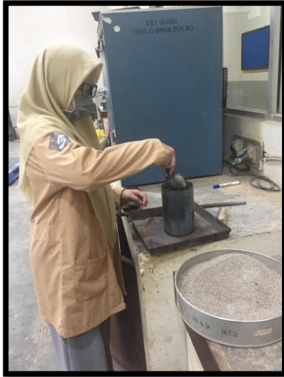
Proses memasukkan benda uji ke dalam tabung silinder
