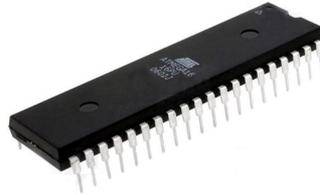
**Gambar 2.2** Mikrokontroler ATmega16
