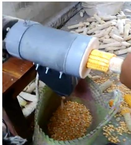
**Gambar 2.2** Mesin pemipil Jagung menggunakan paku dengan daya motor
