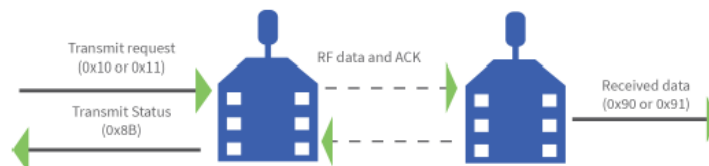
Gambar 2.7 Mengirim dan Menerima Data XBee
