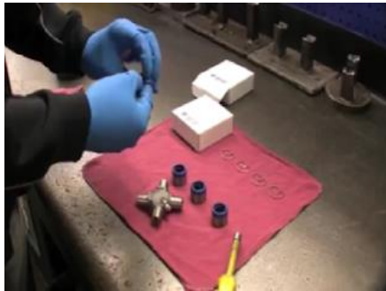
Gambar 2.25 Pemberian grase pada bearing cup
