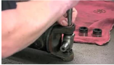
Gambar 2.27 Pemasangan Snap ring
