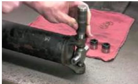
Gambar 2.26 Pemasangan bearing cup
