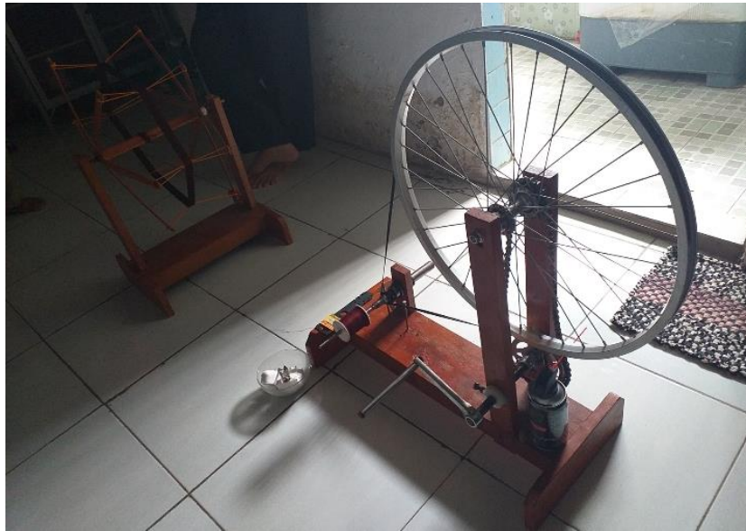
Gambar 2.6 Proses Penggulungan Benang Menggunakan Alat Penggulung Tradisional
