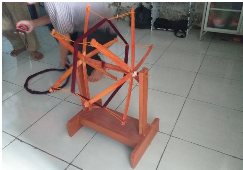
Gambar 2.5 Proses Merentangkan Benang pada Uwingan
