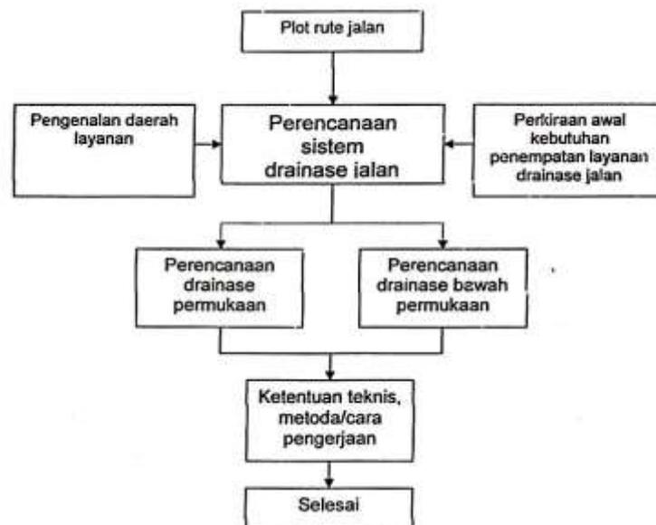
Gambar 2.42 Skema Perencanaan Sistem Drainase Jalan
