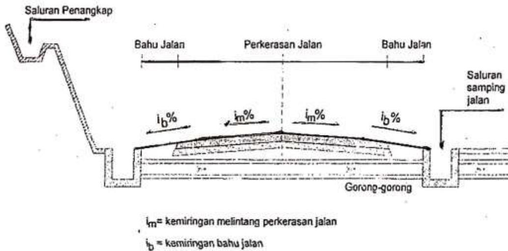
Gambar 2.43 Tipikal Sistem Drainase Jalan
