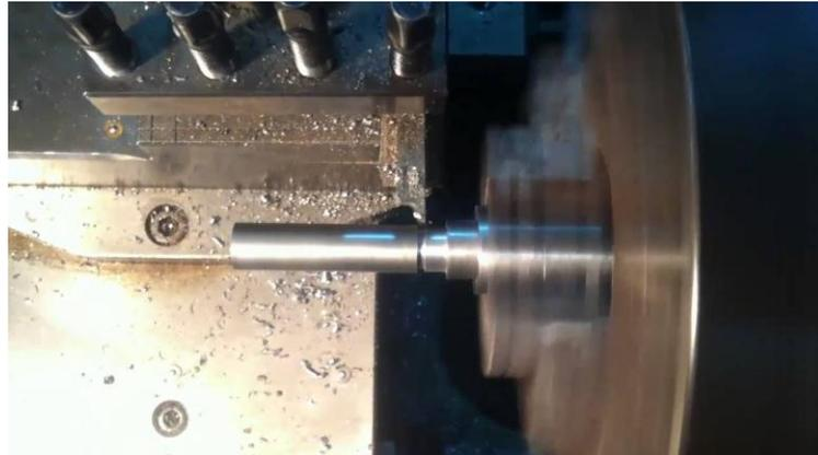
**Gambar 2.7.7.1** Proses *Turning*
