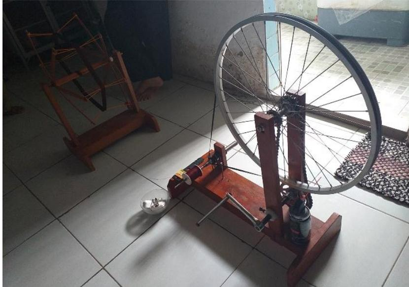
**Gambar 2.6** Proses Penggulungan Benang Menggunakan Alat Penggulung Tradisional
