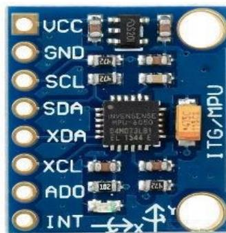
**Gambar 2.30** Komponen Gyroskop GY521 yang berbasis sensor MPU 6050
