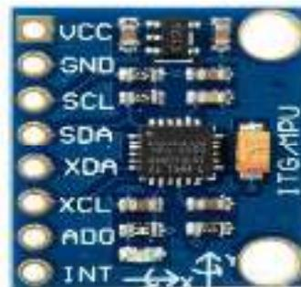
**Gambar 2.30** Gambar Komponen *Gyroscope* GY521 yang berbasis sensor MPU6050
