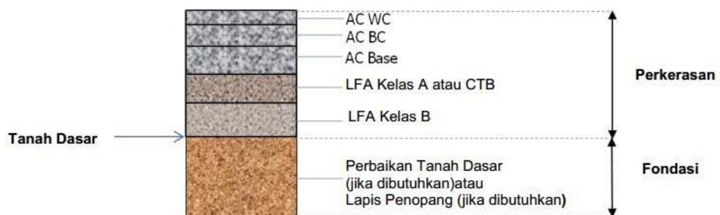
Gambar 2. 24 Struktur perkerasan lentur pada tanah asli ( Bina Marga, 2017 )
