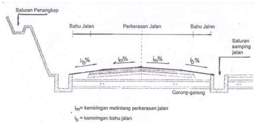
Gambar 2.2 Kemiringan penampang melintang jalan dan bahu jalan
