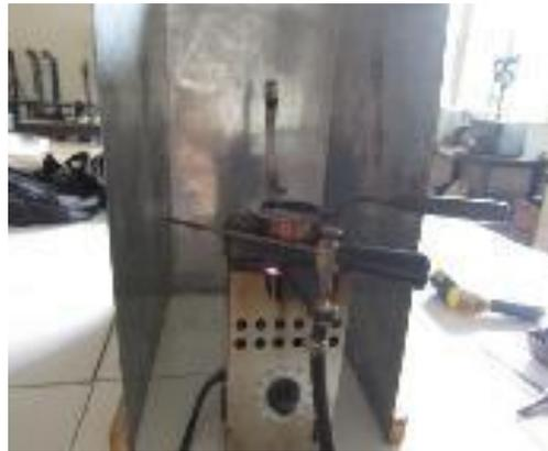
**Gambar 2.9** Alat Pengujian Titik Nyala dan Titik bakar
