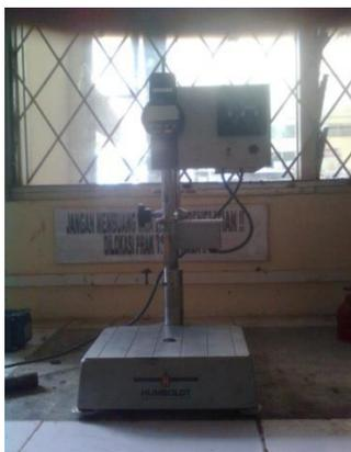
**Gambar 2.7** Alat Penetrasi Aspal
