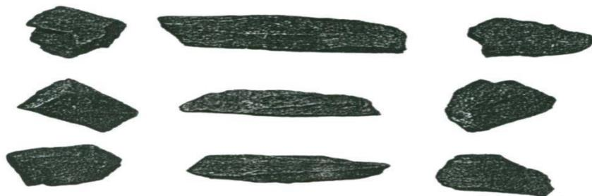
**Gambar 2.4** Bentuk-Bentuk Agregat
