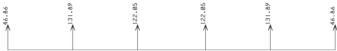
Gambar 3.58 Perletakan Gaya Akibat Beban Mati Tie beam Melintang
