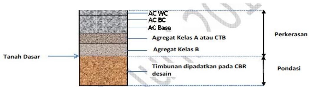
Gambar 2.26 Lapisan Perkerasan Lentur Pada Timbunan
