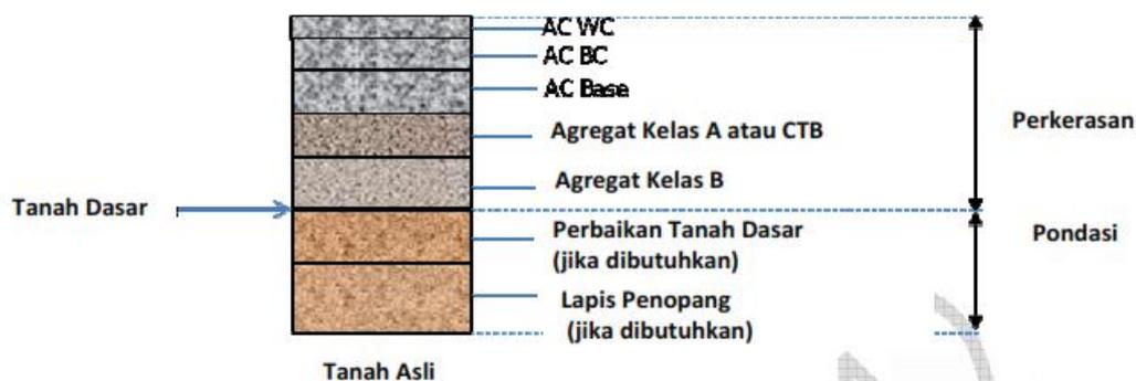
Gambar 2.25 Lapisan Perkerasan Lentur Pada Permukaan Tanah Asli
