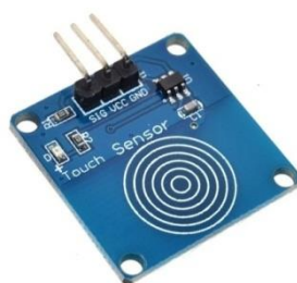
Gambar 2.6 Bentuk Fisik Sensor Sentuh
