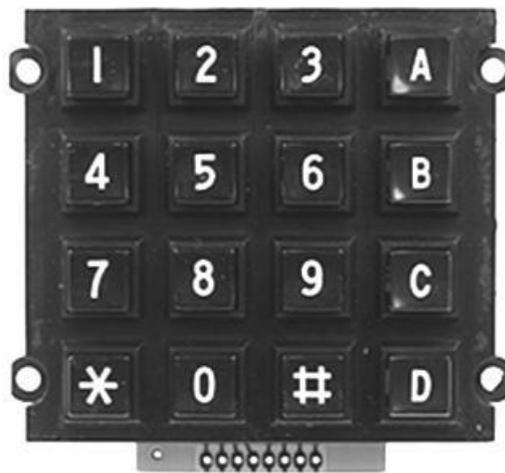
**Gambar 2.2** Bentuk Fisik Rangkaian Keypad.
