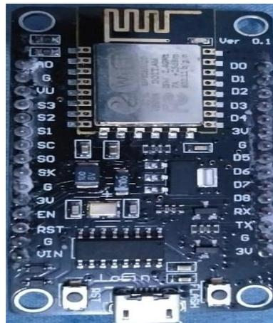
**Gambar 2.1** Modul *Wifi* Esp8266 Nodemcu
