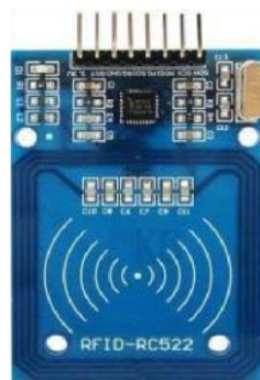
Gambar 2.3 Bentuk fisik modul RFID MIFARE RC522
