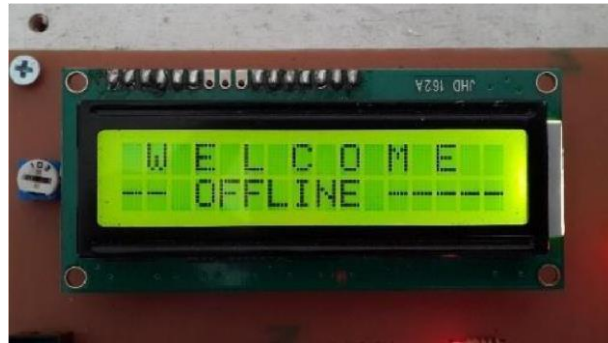
Gambar 2.10 Bentuk fisik LCD
