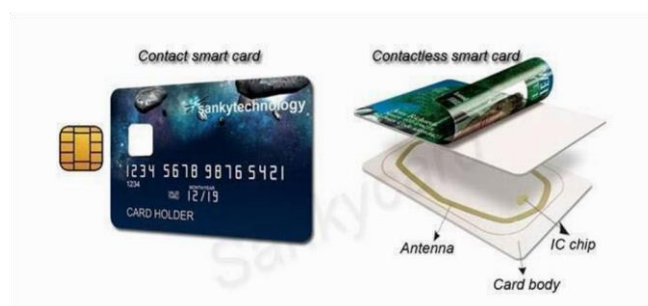
Gambar 2.2 Contoh Smart Card dengan teknologi Contact Card dan Contactless Card
