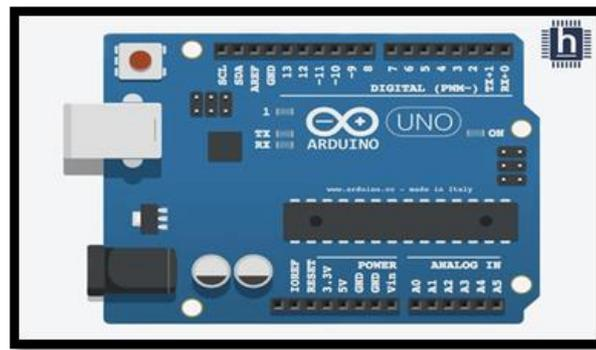
**Gambar 2.2** Modul Mikrokontroler Arduino Uno
