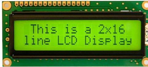
**Gambar 2.2** Bentuk Fisik LCD 16 x 2
