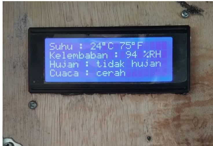
Gambar 4.8 Tampilan Data pada LCD pada Saat Pengujian Cara Kerja Alat Monitoring Cuaca Jarak Jauh Berbasis Internet of Thing
