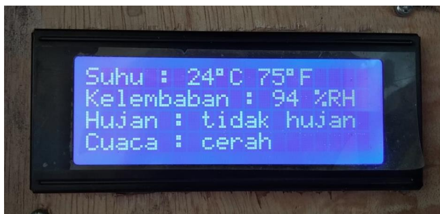
Gambar 4.7 Tampilan LCD Pembacaan Nilai Sensor Dari Alat Monitoring Cuaca Jarak Jauh Berbasis Internet of Thing
