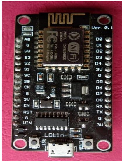
**Gambar 2.2** Modul *Wifi* ESP8266 NodeMCU
