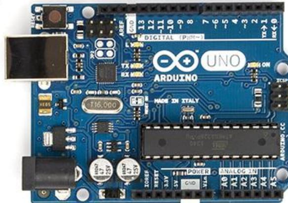
**Gambar 2.1** Module Mikrokontroler Arduino Uno
