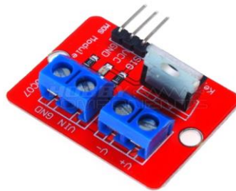
Gambar 2.7 Bentuk fisik modul mosfet
