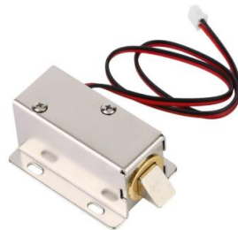
Gambar 2.8 Bentuk Fisik Solenoid Door Lock
