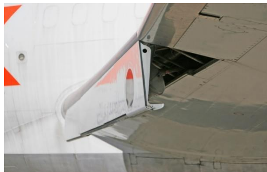
Gambar 2.9 Krueger flap pada pesawat B727
