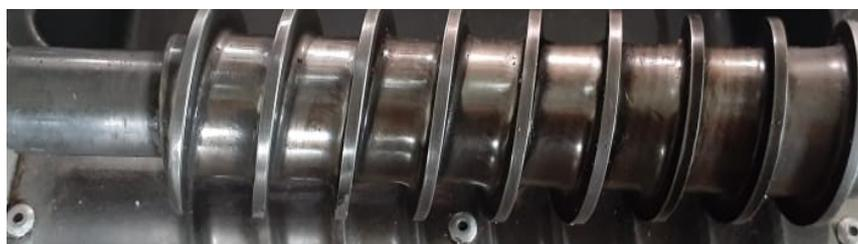
**Gambar 2.4** *Screw* pada Alat *Press* Minyak
