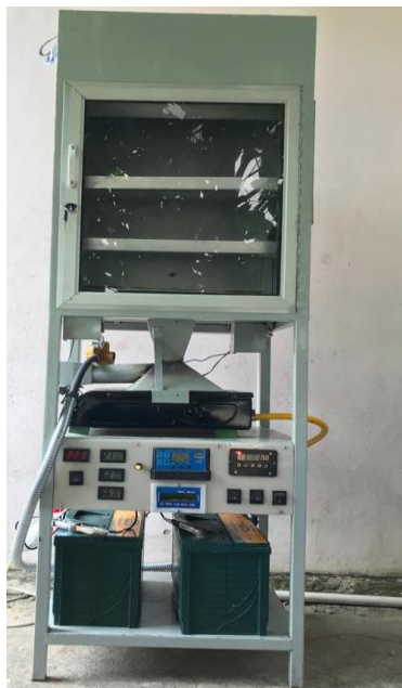
Alat Pengering Surya Tipe Rak
