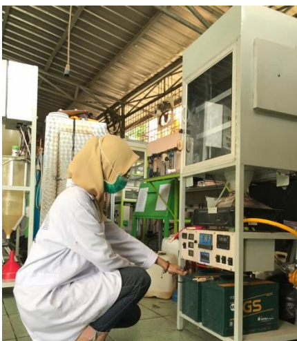
Proses Merangkai Sambungan Aki
