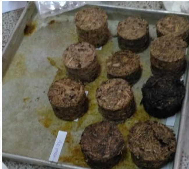
Gambar L3.7 Proses Pembuatan Bahan Bakar Padat
