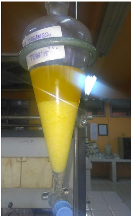
Gambar III.5 Proses Pemisahan dan Pencucian Minyak Pada Temperatur Pengepresan 100°C Pada Proses Degumming
