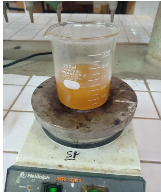
Gambar III.4 Proses Pemanasan Minyak dan Penambahan Asam Pospat serta Aquadest Saat Proses Degumming
