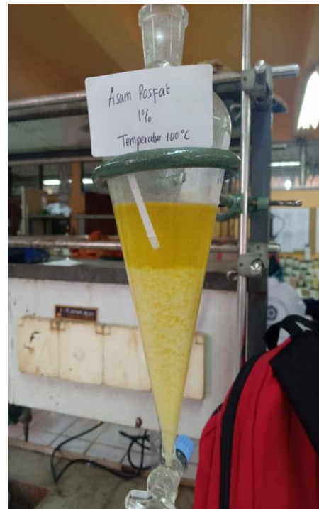
Gambar III.5 Proses Pemisahan dan Pencucian Minyak Pada Temperatur Pengepresan 100°C Pada Proses Degumming
