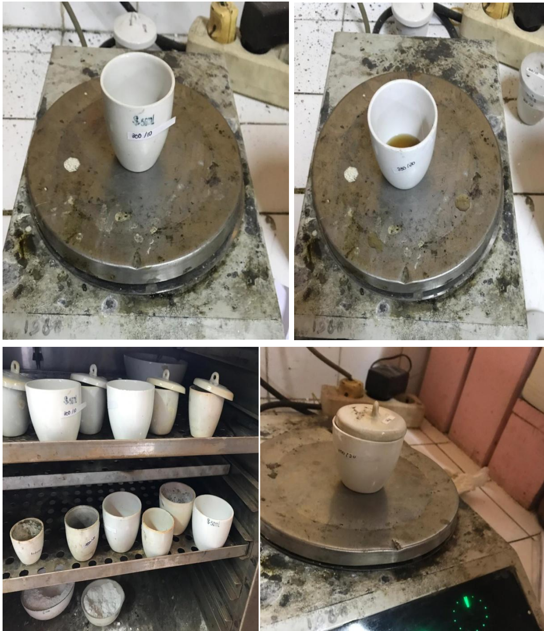
Gambar III.13 Analisa Penentuan Kadar Air Pengepresan Minyak Sebelum dan Setelah Proses Degumming
