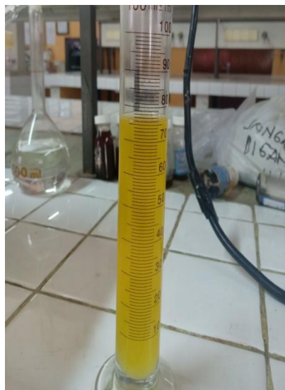
Gambar III.7 Minyak Pengepresan Temperatur 100°C Setelah Degumming
