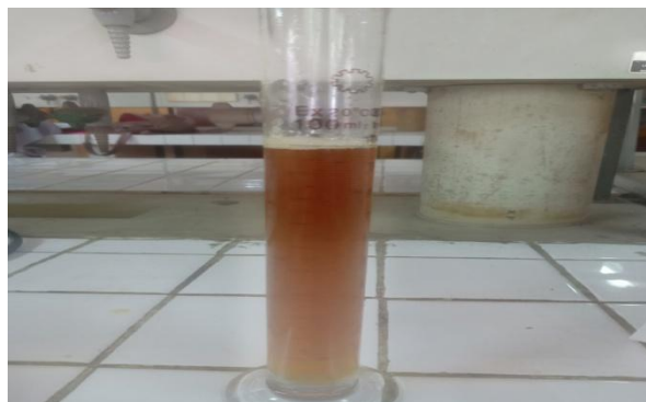
Gambar III.3 Minyak Biji Kapuk Sebelum di Proses Degumming
