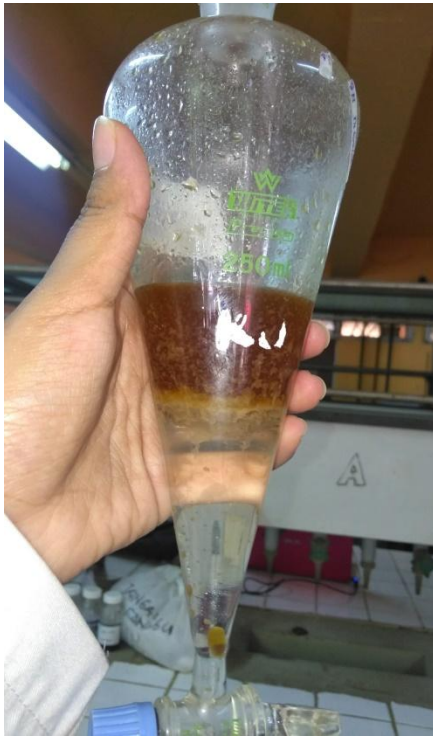
Gambar III.6 Proses Pemisahan dan Pencucian Minyak Pada Temperatur 150°C
