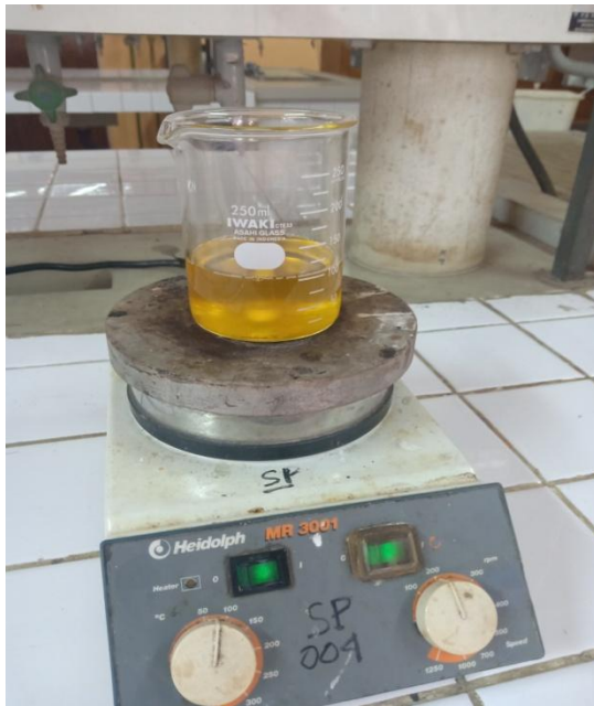
Gambar III.4 Proses Pemanasan Minyak dan Penambahan Asam Pospat serta Aquadest Saat Proses Degumming
