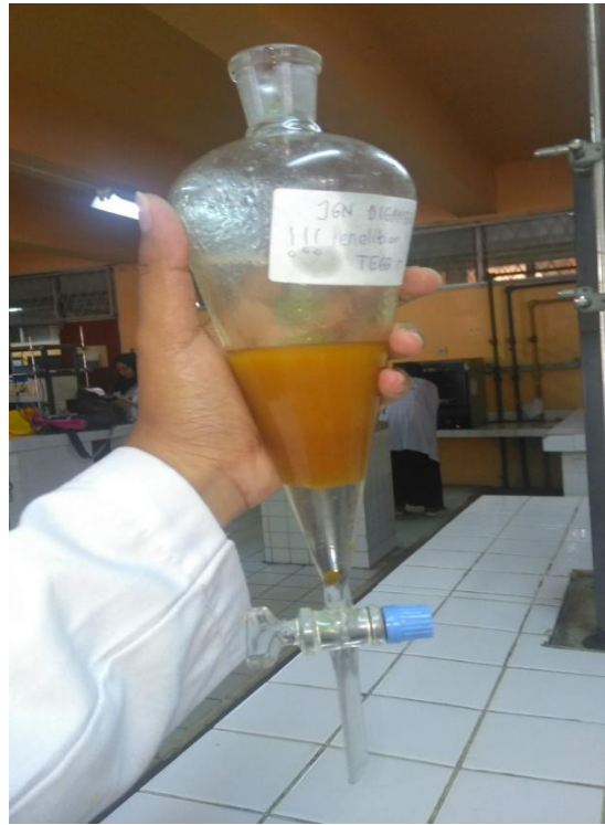
Gambar III.6 Proses Pemisahan dan Pencucian Minyak Pada Temperatur 150°C
