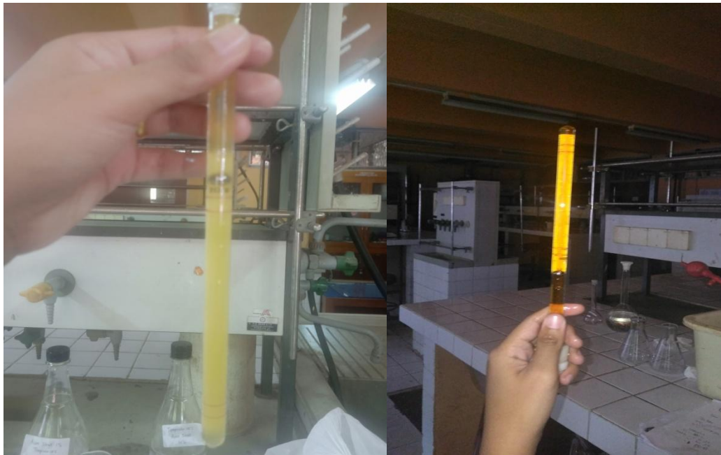
Gambar III.12 Analisa Penentuan Viskositas Pengepresan Minyak Sebelum dan Setelah Proses Degumming
