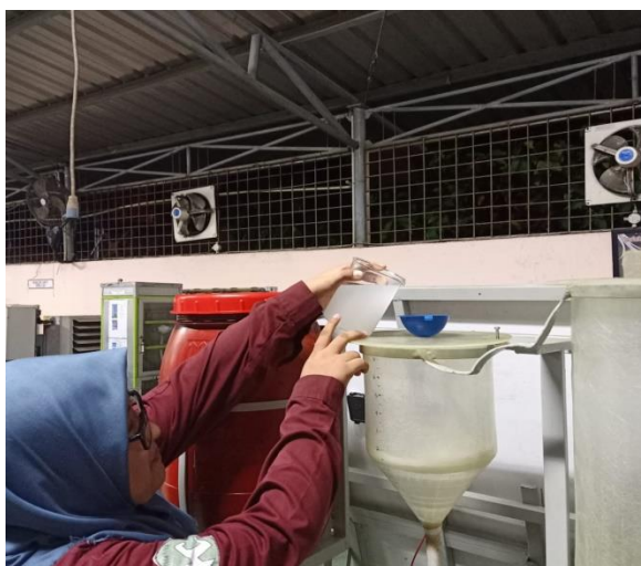
Gambar C.13. Menuangkan Katalis ke Tangki Katalis lalu Mengalirkannya ke Tangki Reaktor untuk melakukan Proses Transesterifikasi pada Suhu 60°C
