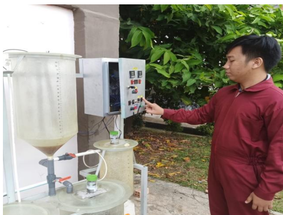
Gambar C.14. Proses Mengalirkan Hasil Reaksi Transesterifikasi kedalam Tangki Pemisahan
