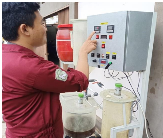
Gambar C.12. Proses Pemanasan Minyak Jelantah Sampai Suhu 60°C
