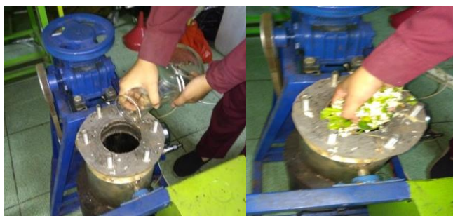
Gambar LIII.11. Proses Memasukkan Air dan bahan baku (Sampah Organik) kedalam Reaktor
