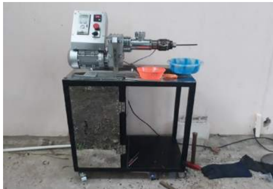
Gambar L3.2 Proses Pengepresan Biji Karet
