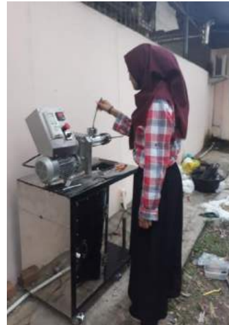
Gambar L3.2 Proses Pengepresan Biji Karet
