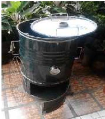
**Gambar 2.4.** Alat Pengasap Model Drum
