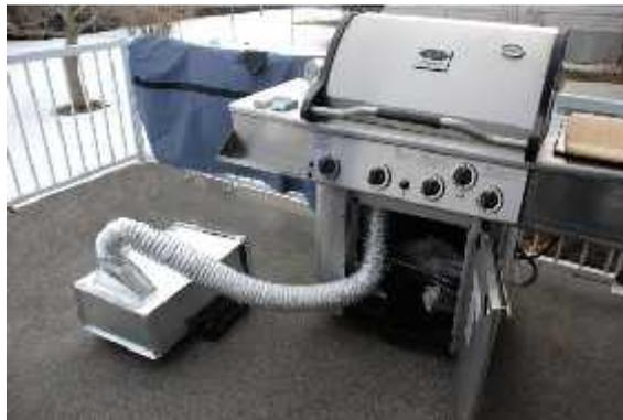
**Gambar 2.5** Proses Pengasapan secara Tidak Langsung
