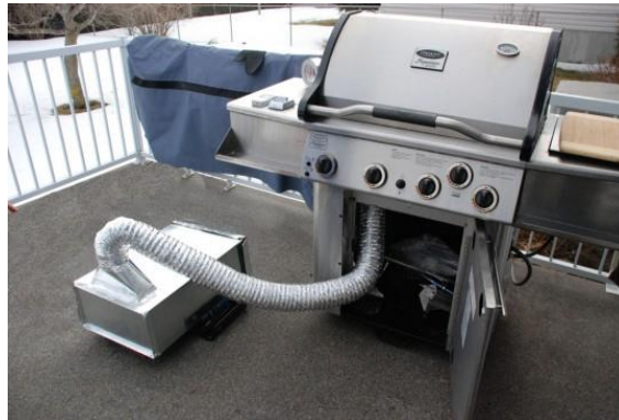
Gambar 2.6 Proses Pengasapan secara Tidak Langsung
