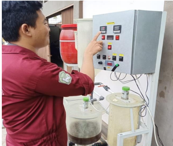
Gambar C.12. Proses Pemanasan Minyak Jelantah Sampai Suhu 60^{\circ}\text{C}
