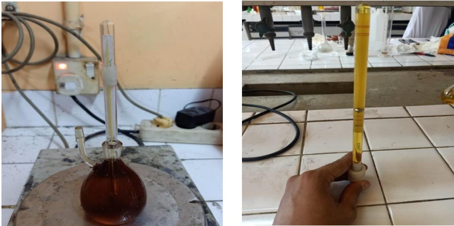
Gambar C.18. Analisa Densitas dan Viskositas pada Minyak Jelantah
