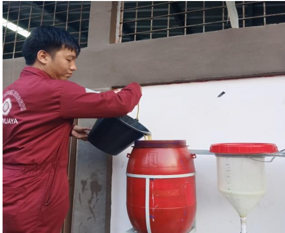
Gambar C.9. Proses Memasukkan Minyak Jelantah pada Tangki Umpan
