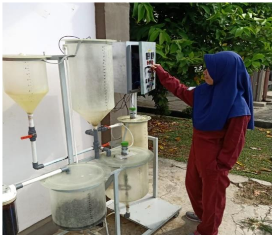
Gambar C.11. Proses Mengalirkan Minyak Jelantah dari Tangki Penampungan kedalam Reaktor
