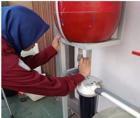
Gambar C.10. Proses Filtrasi Minyak Jelantah Menggunakan Karbon Aktif Menuju Tangki Penampungan
