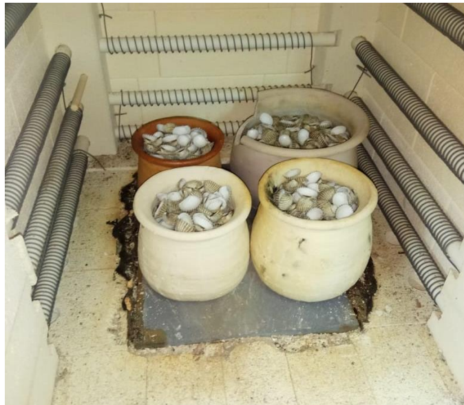
Gambar C.5. Proses Pembuatan Katalis CaO dari Cangkang Kerang Darah
