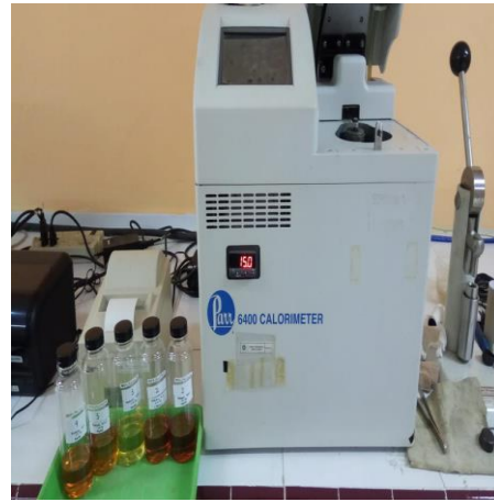
Gambar C.22. Analisa Titik Nyala dan Nilai Kalor Biodiesel
