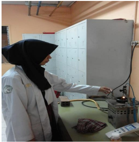
Gambar C.22. Analisa Titik Nyala dan Nilai Kalor Biodiesel
