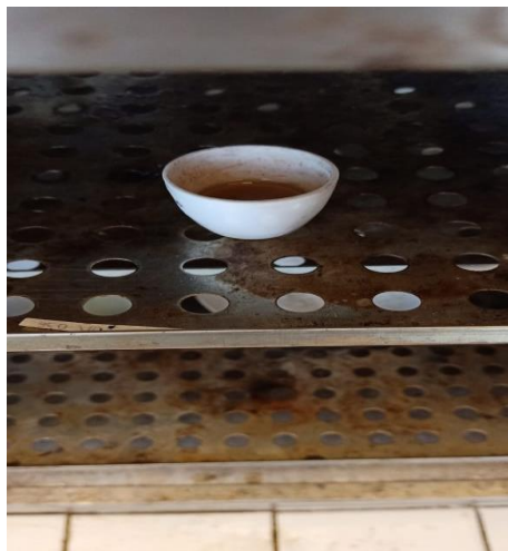
Gambar C.19. Analisa Kadar Air pada Minyak Jelantah
