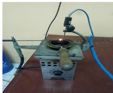
Gambar C.17. Analisa Kadar Asam Lemak Bebas dan Titik Nyala pada Minyak Jelantah
