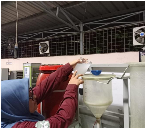
Gambar C.13. Menuangkan Katalis ke Tangki Katalis lalu Mengalirkannya ke Tangki Reaktor untuk melakukan Proses Transesterifikasi pada Suhu 60^{\circ}\text{C}
