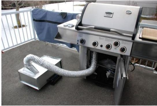
**Gambar 2.6** Proses Pengasapan secara Tidak Langsung
