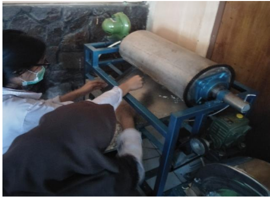
Gambar 7. Chip hasil fermentasi dikeringkan di rotary dryer
