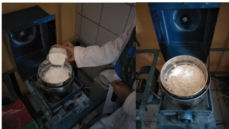
Gambar 11. Tepungdiayak di vibrating screen
