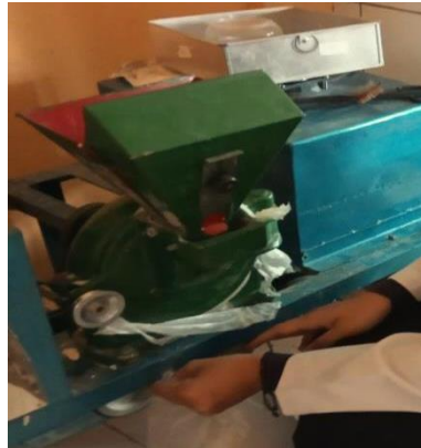
Gambar 9. Chip hasilpengeringan, digiling di diskmil
