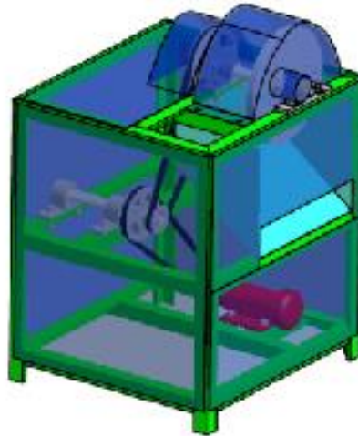
Sumber : Proyek Akhir Budiyanto, Tahun 2012. Gambar 2. Mesin perajang singkong vertikal.
