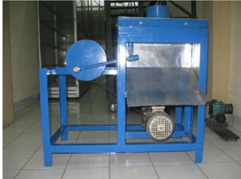
Sumber : Jurnal Rekayasa Mesin Vol.1, No. 2 Tahun 2010. Gambar 1. Perajang Ubi Kayu Pisau Horizontal.
