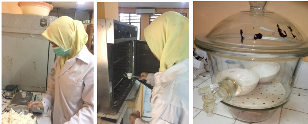
Gambar 15. Uji Kadar Air (a) Sampel & Cawan di Timbang, (b) Sampel di Keringkan, dan (c) Didinginkan di Desikator
