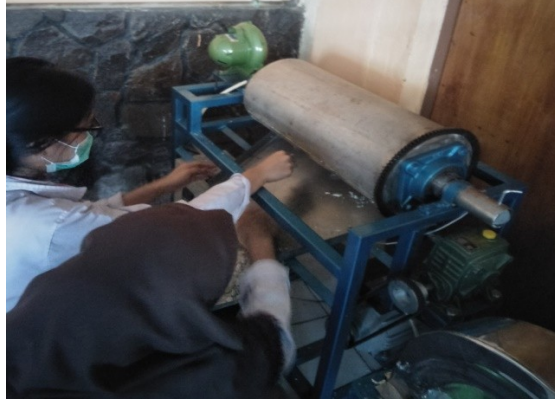
Gambar 7. Chip hasil fermentasi dikeringkan di rotary dryer
