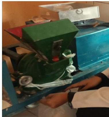
Gambar 9. Chip hasil pengeringan, digiling di diskmil
