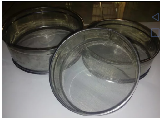
Gambar 12. screen yang digunakan berukuran 60, 80, 100 mesh
