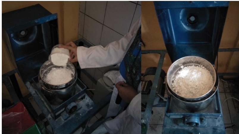
Gambar 13. Pengayakan tepung dengan vibrating screener
