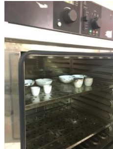
Gambar 16. Uji Kadar Air (a) Penimbangan, (b) Pemanasan dalam Oven, (c) Penyerapan panas dalam Desikator
