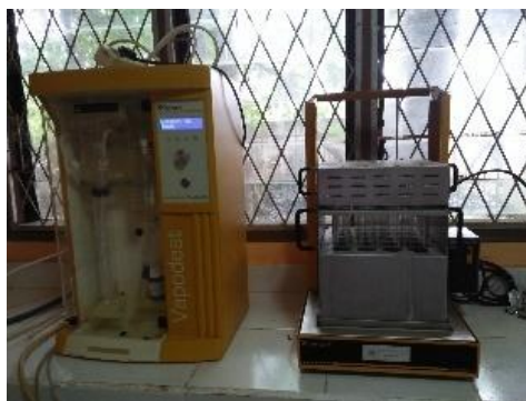
Gambar 17. Uji Kadar Protein dengan metode Kjedhal
