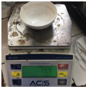
Gambar 16. Uji Kadar Air (a) Penimbangan, (b) Pemanasan dalam Oven, (c) Penyerapan panas dalam Desikator
