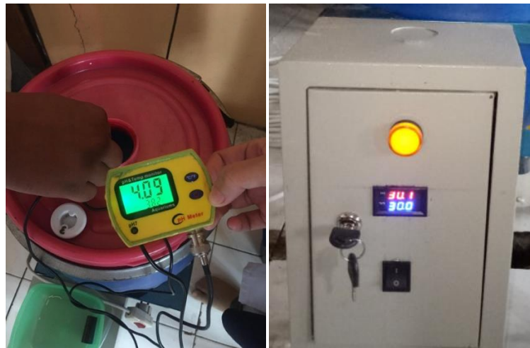
Gambar 7. Pengecekan pH dan Temperatur Selama Fermentasi
