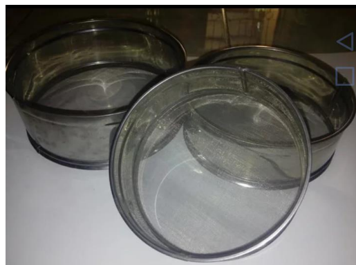
Gambar 14. Screener yang digunakan (ukuran 60, 80, 100 mesh )
