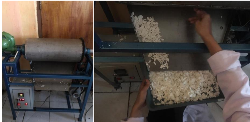
Gambar 9. Pengeringan chips hasil fermentasi dengan rotary dryer
