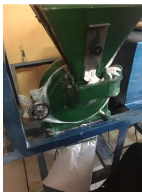
Gambar 11. Penggilingan chips hasil pengeringan dengan discmill
