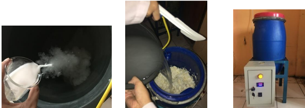
Gambar 6. Proses fermentasi Bahan Baku (Singkong, Starter BAL dan Air) dalam Fermentor Mocaf
