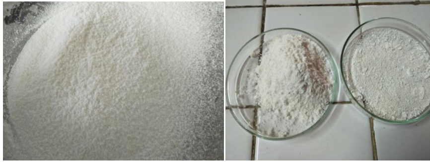
Gambar 15. (a) Hasil pengayakan tepung mocaf, (b) Undersize dan oversize
