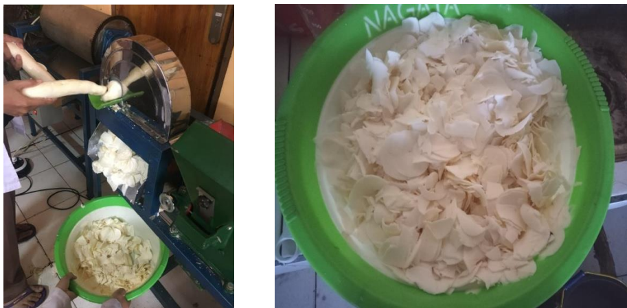
Gambar 4. Perajangan singkong menjadi bentuk chips
